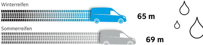
ABS-Bremsverzögerung von 100 auf 0 km/h bei 5°C Aussentemperatur auf nasser Strasse.
