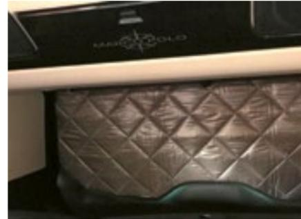
**Isolierfaltenbalg Aufstelldach** MP MPH MPA
