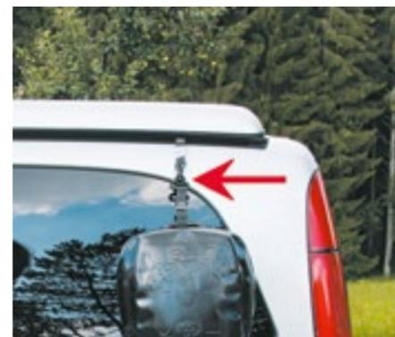
**Halterung für Solardusche/Faltwasserbehälter zur Aufhängung der Behälter an TOP-RAIL oder Kederschiene**
